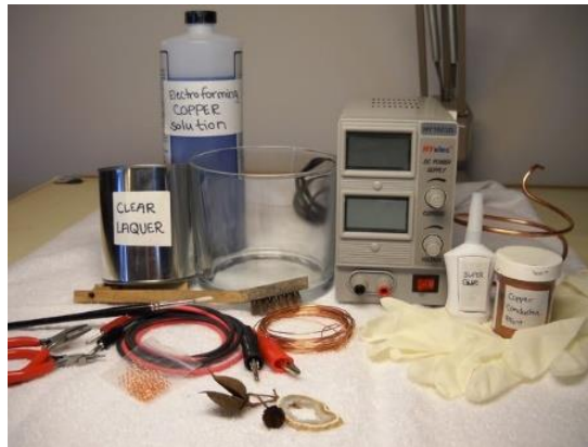
شکل (3): تجهیزات لازم برای الکتروفرم مس .
